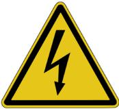
Das Symbol mit einem Blitz in einem gleichschenkeligen Dreieck warnt den Benutzer vor einer gefährlichen Hochspannung ohne elektrische Isolierung. Im inneren des Gehäuses kann die Spannung hoch genug sein um einen tödlichen Stromschlag zu verursachen.
